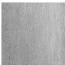
2. 白錆が出てすぐの状態
