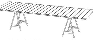
1.架台の上に天板を置きます。 この時、脚を簡単に取り付けられるように、 架台をテーブルの端に近づけ過ぎないでください。
